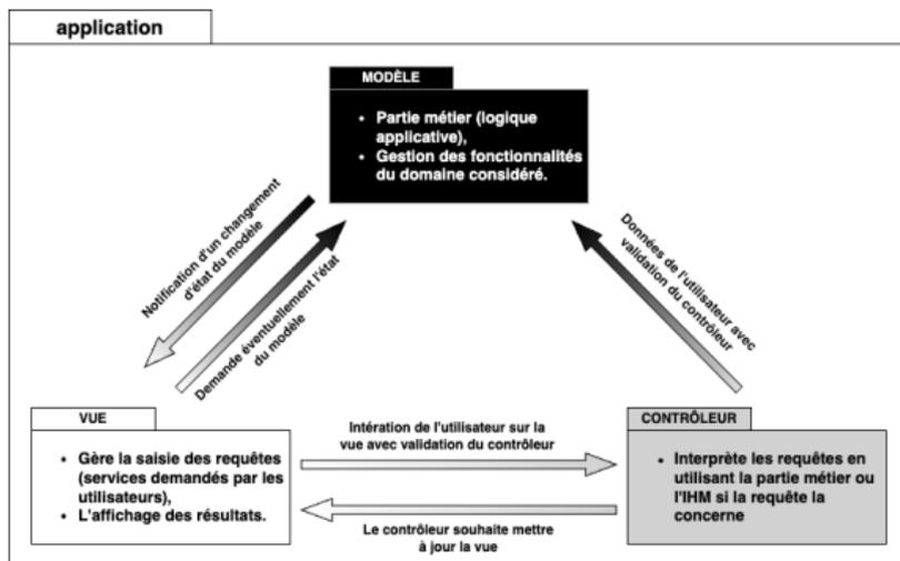
**Contrôleur** : gère le flux de contrôle de l'application et la coordination modèle-vue
